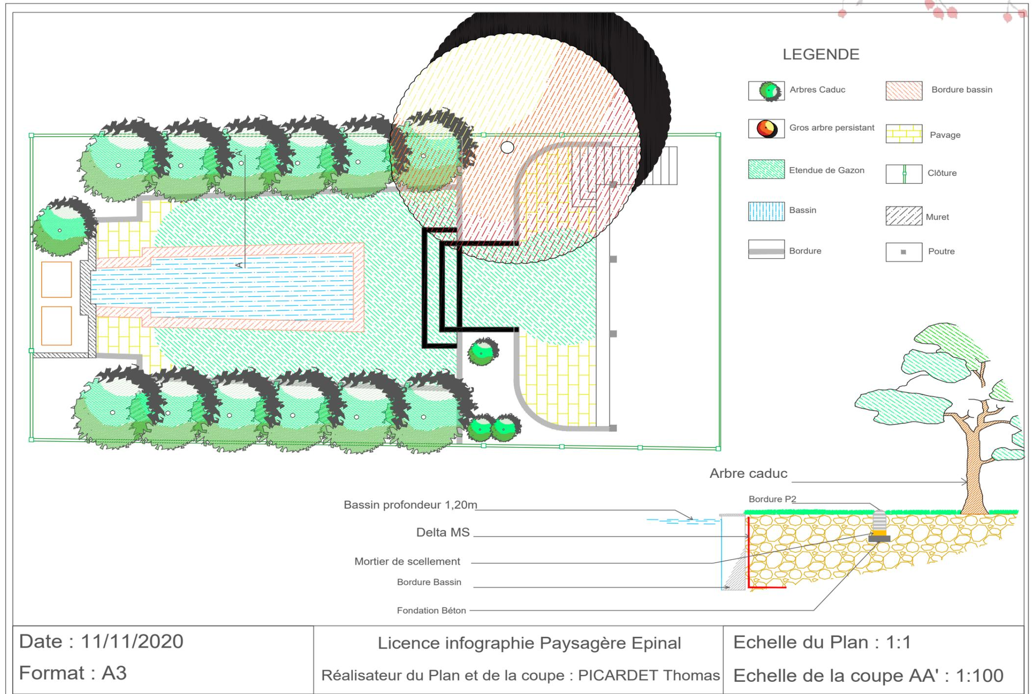
Plan masse réalisé sur le logiciel AutoCAD.
